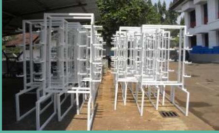
Rangka besi holo yang digunakan pada wolkaponik versi talang dan paralon
