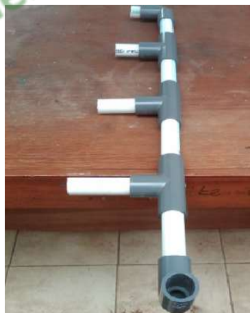
Rangkaian pipa paralon yang dihubungkan dengan sambungan T dan L
