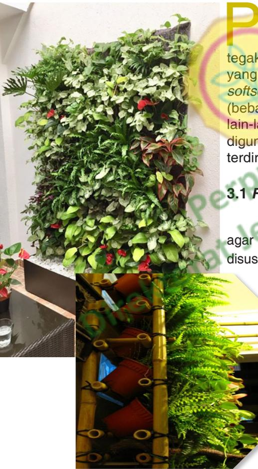
Gambar 20. Vertikal garden menggunakan *frame wiremesh* dan *frame bambu*
